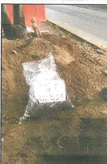
EN LAS FOTOGRAFÍAS ANTERIORES SE MUESTRA EL PROCESO DE EXPLORACIÓN DEL SUELO A TRAVÉS DEL POZO A CIELO ABIERTO, ASÍ COMO LA TOMA DE LA MUESTRA ALTERADA.
