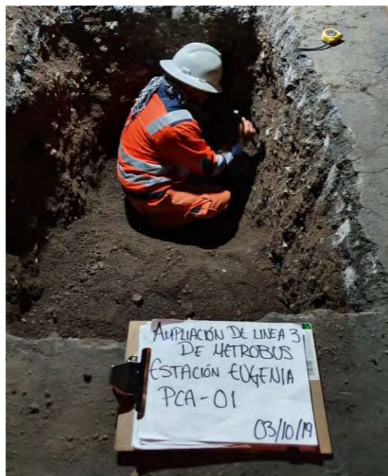
Figura 3. Levantamiento geotécnico y muestreo PCA-01
