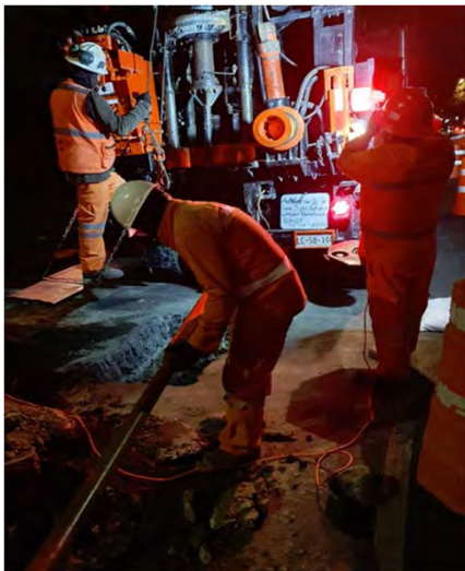
Figura 3. Maniobra de extracción de muestra inalterada PCA-01
