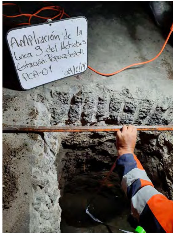
Figura 2.2. Muestreo y levantamiento geotécnico del PCA-01
