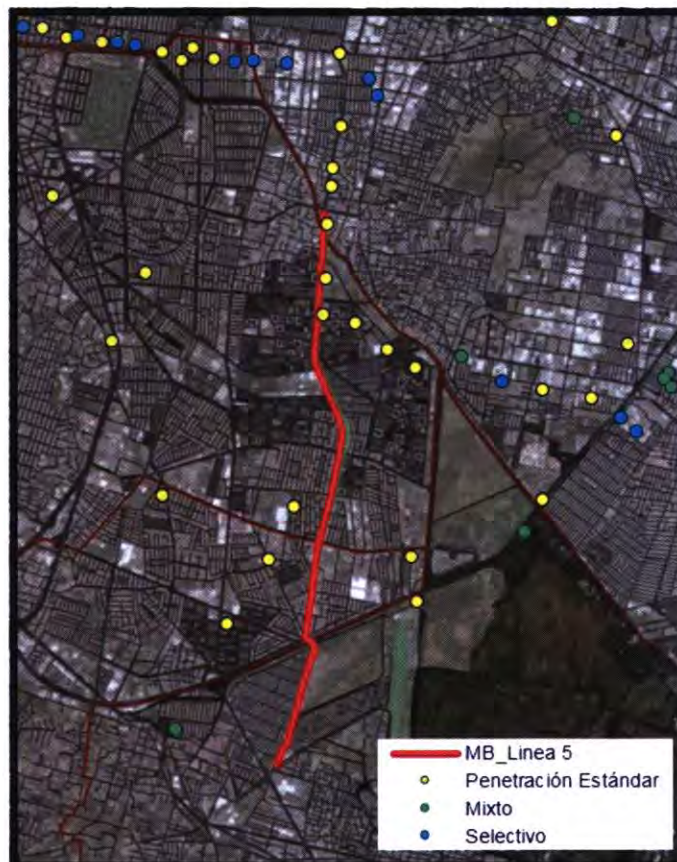
Fig. 11. Localización del trazo de la Línea 5 del METROBÚS y sondeos utilizados en el análisis geoestadístico del contenido de agua.
