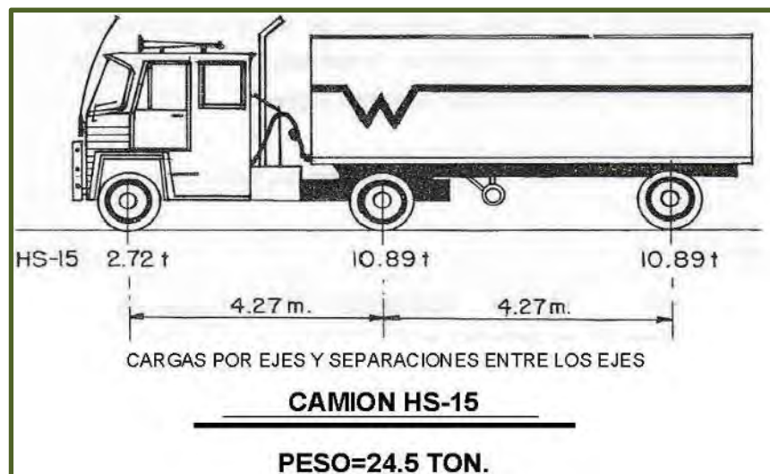
Figura No. 14.- Características de dimensiones y cargas para camión tipo HS-15.
