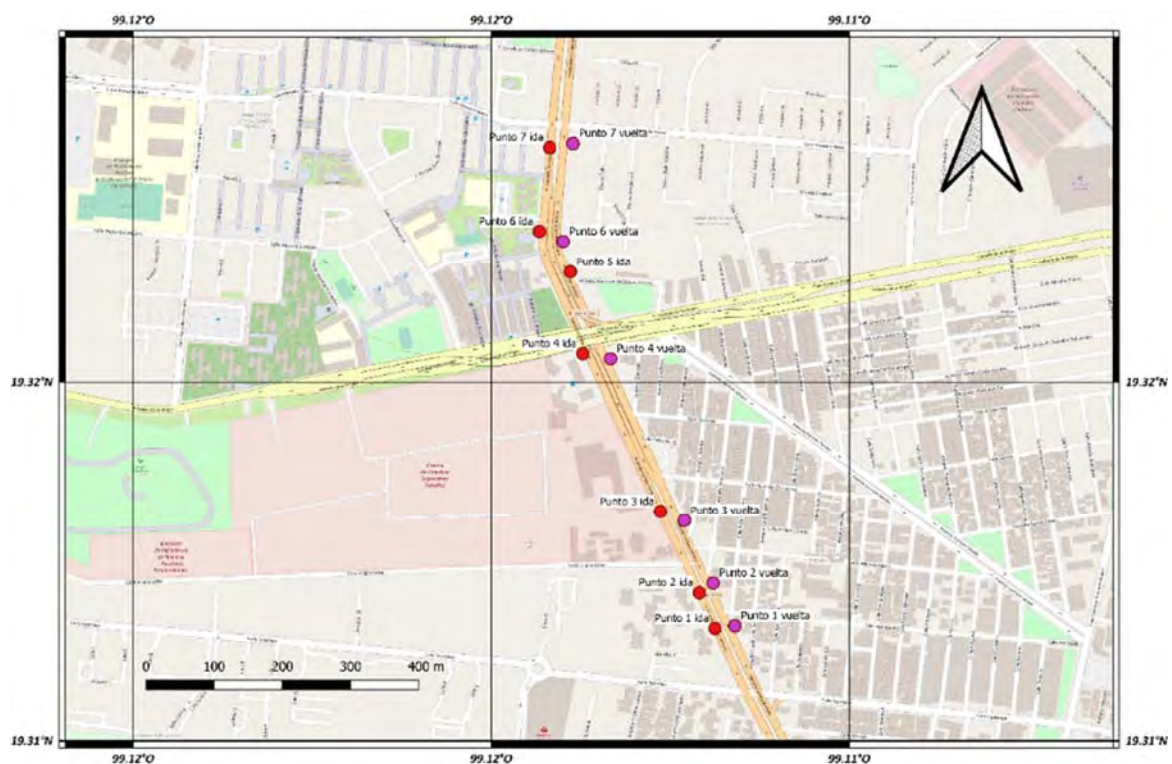
Figura No. 17.- Estaciones en donde se realizó la medición de vibración por paso del Metrobús y tránsito normal de la vialidad.
