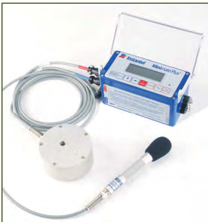
Figura No. 18.- Instrumento de marca Instantel utilizado para medir las vibraciones causadas por las fuentes móviles.
