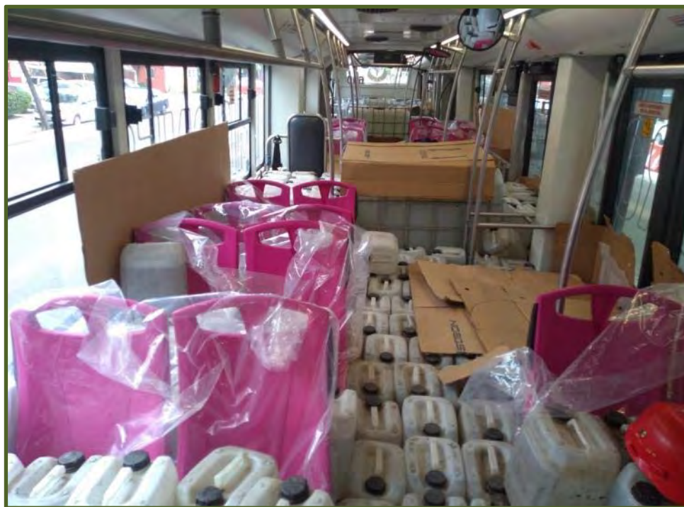
Fotografía No. 12.- Vista al interior del camión de Metrobús usado en los trabajos de campo, se cargó con galones de agua, para simular la carga máxima de operación, 140 pasajeros.
