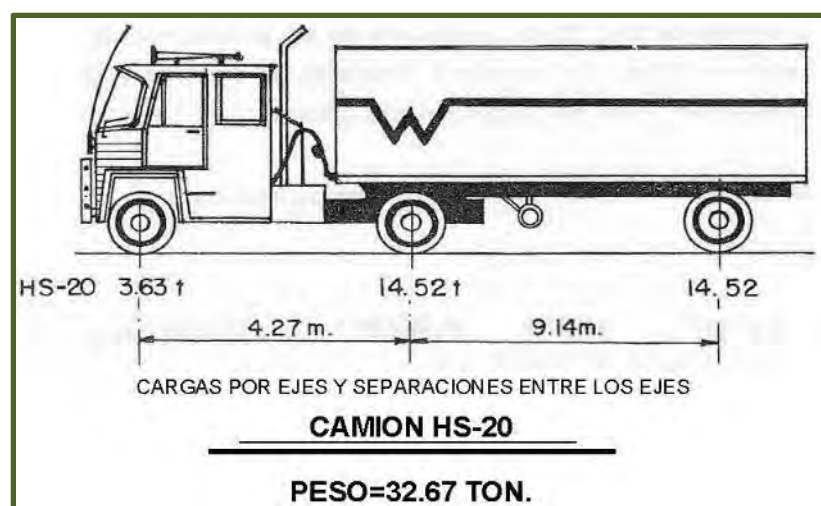
Figura No. 13.- Características de dimensiones y cargas para camión tipo HS-20.
